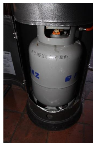
Een nog goede heater. Ook hier is goed te zien dat de opening krap is en de onderkant ingedeukt.
