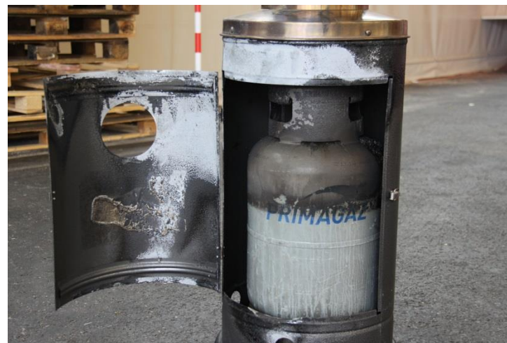
De verbrande heater. De onderrand van de opening is door de eigenaar ingedeukt om de fles makkelijker te kunnen wisselen.
